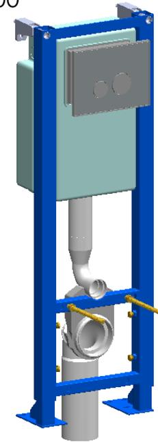
Détail des trous de fixation du châssis et de la position et diamètre du tuyau d'évacuation.
