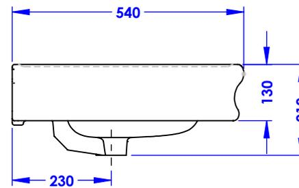
Ø de perçage et entre-axe recommandés.
