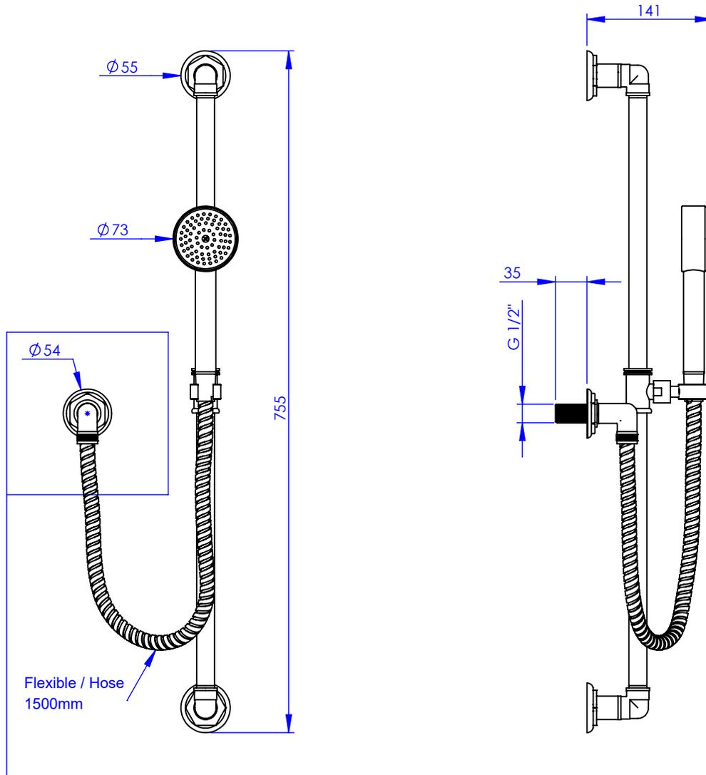
**Débit / Flow rate : 10 l/min sous 3 bars.**
