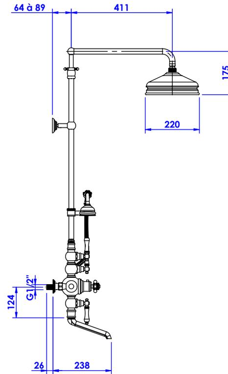
Débit / Flow rate : 18 l/min (sous 3 bars).
