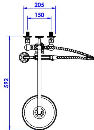
$\varnothing$  de perçage et entraxe recommandés.
