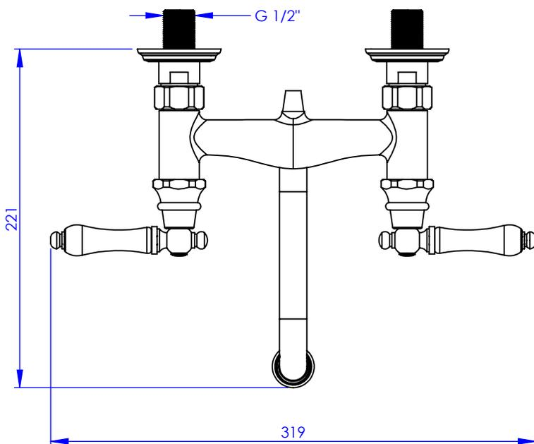
Ø de perçage et entra-axe recommandés.
