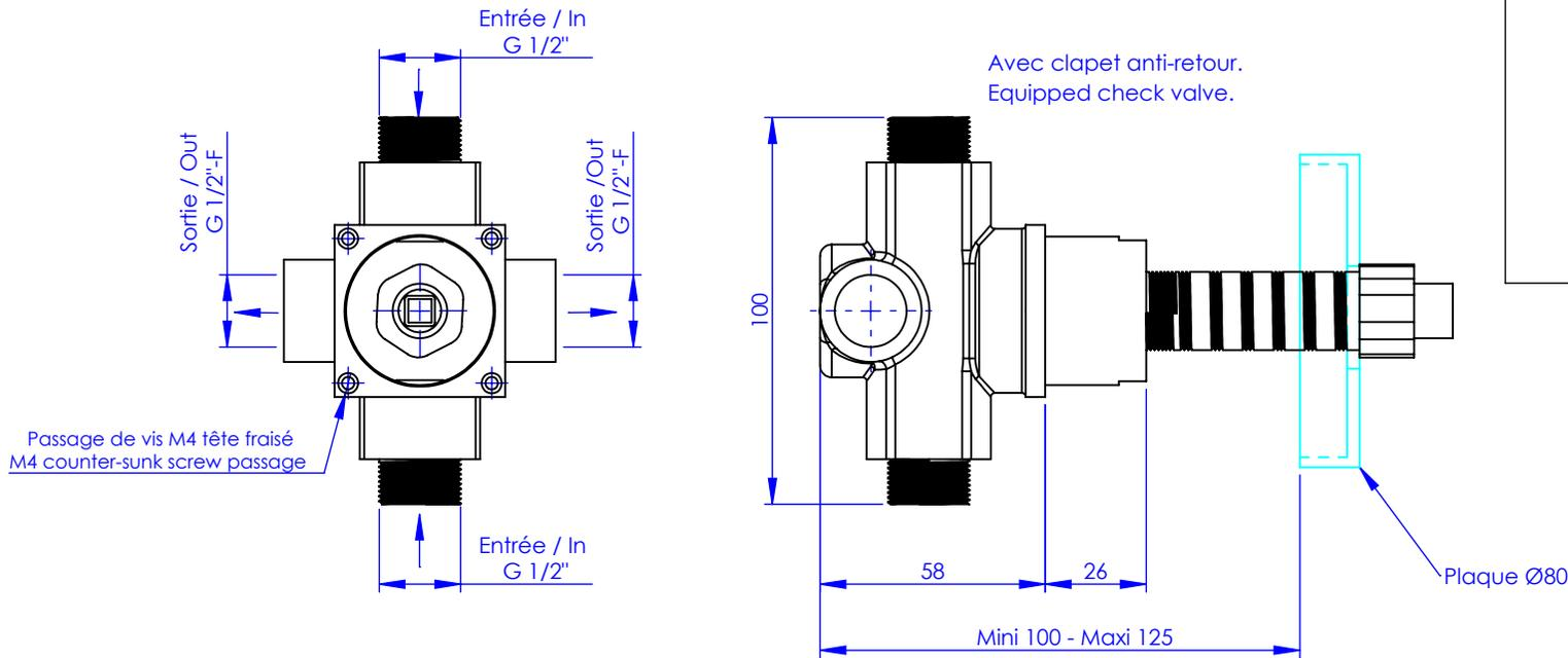
**Débit / Flow rate : 30 l/min sous 3 bars.**
