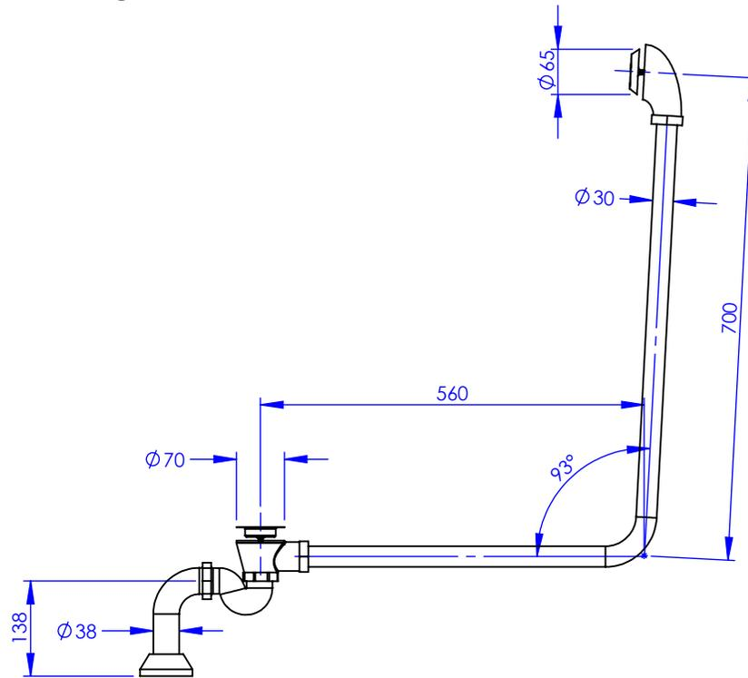
**Fournie avec chaînette en laiton 720mm et bouchon en laiton**
