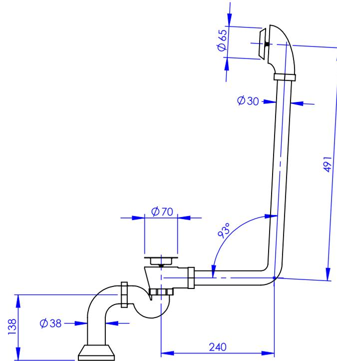
**Fournie avec chaînette en laiton 520mm et bouchon en laiton**
