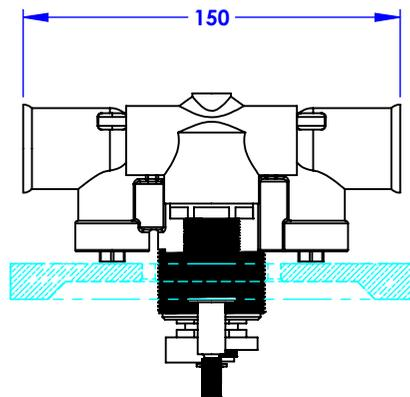
Débit / Flow rate : 55 l/min sous 3 bars.
